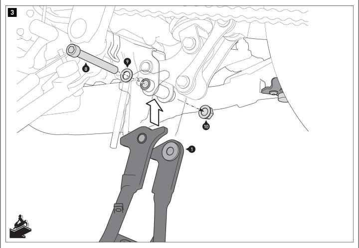
Avvitare il cavalletto centrale (1) al veicolo. Serrare la vite (8) come specificato nelle istruzioni per il montaggio.
