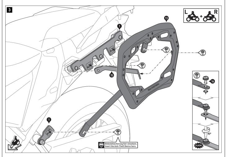
Collegare i telai laterali (13) e (14) alle staffe di montaggio (1) e (5) quindi al connettore a croce (5) avvalendosi delle chiusure rapide (15). Fissare le chiusure rapide con le rondelle di sicurezza.
