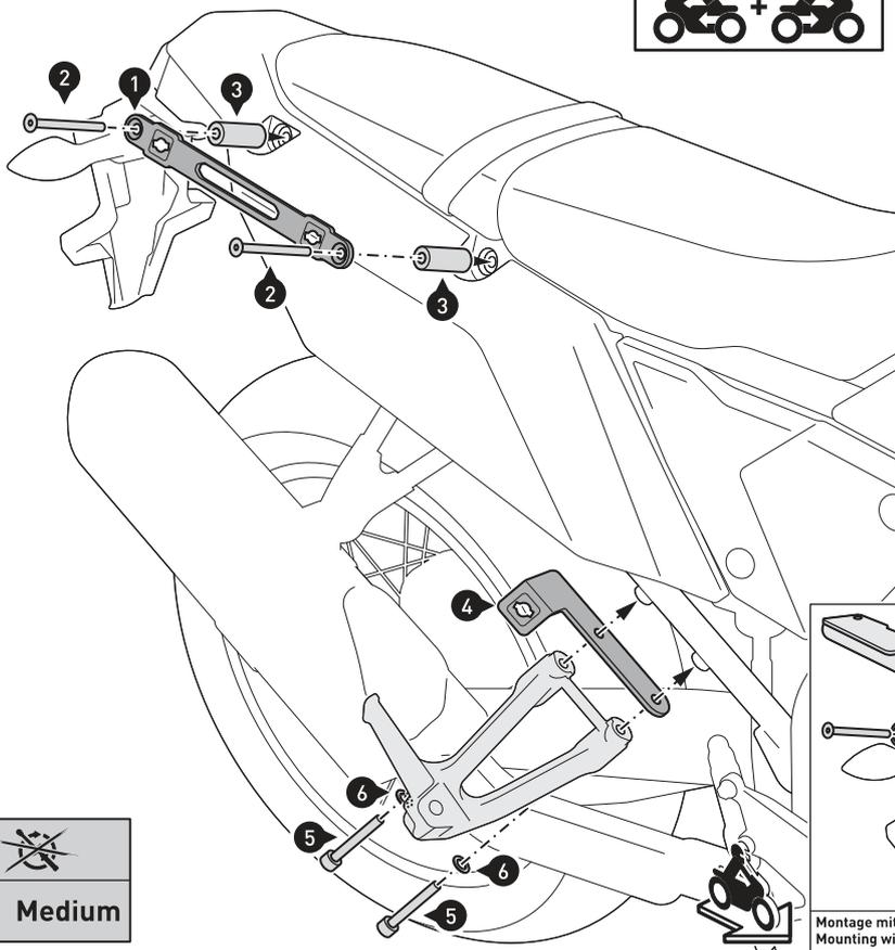
**HINWEIS:** Wenn der Seitenträger mit dem SW-MOTECH Gepäckträger montiert wird, entfallen die Distanzbuchsen (3). Montieren Sie stattdessen die markierten (\*) Teile des Gepäckträgers.
