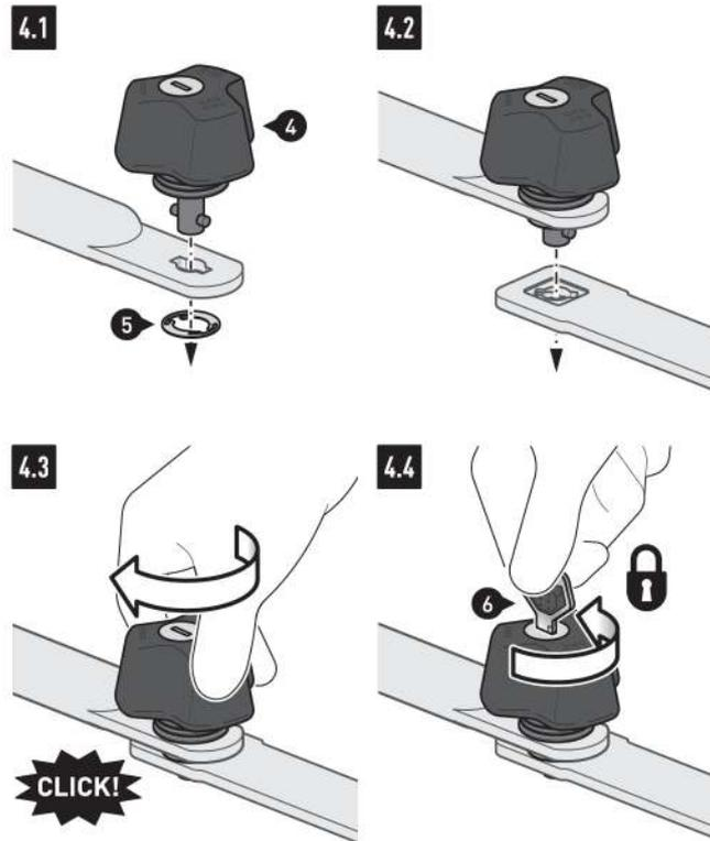
**Montaggio dell'antifurto per telaio laterale PRO**
