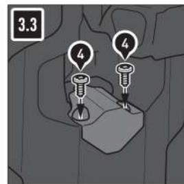
**Installare il connettore dell'alloggiamento della serratura**
