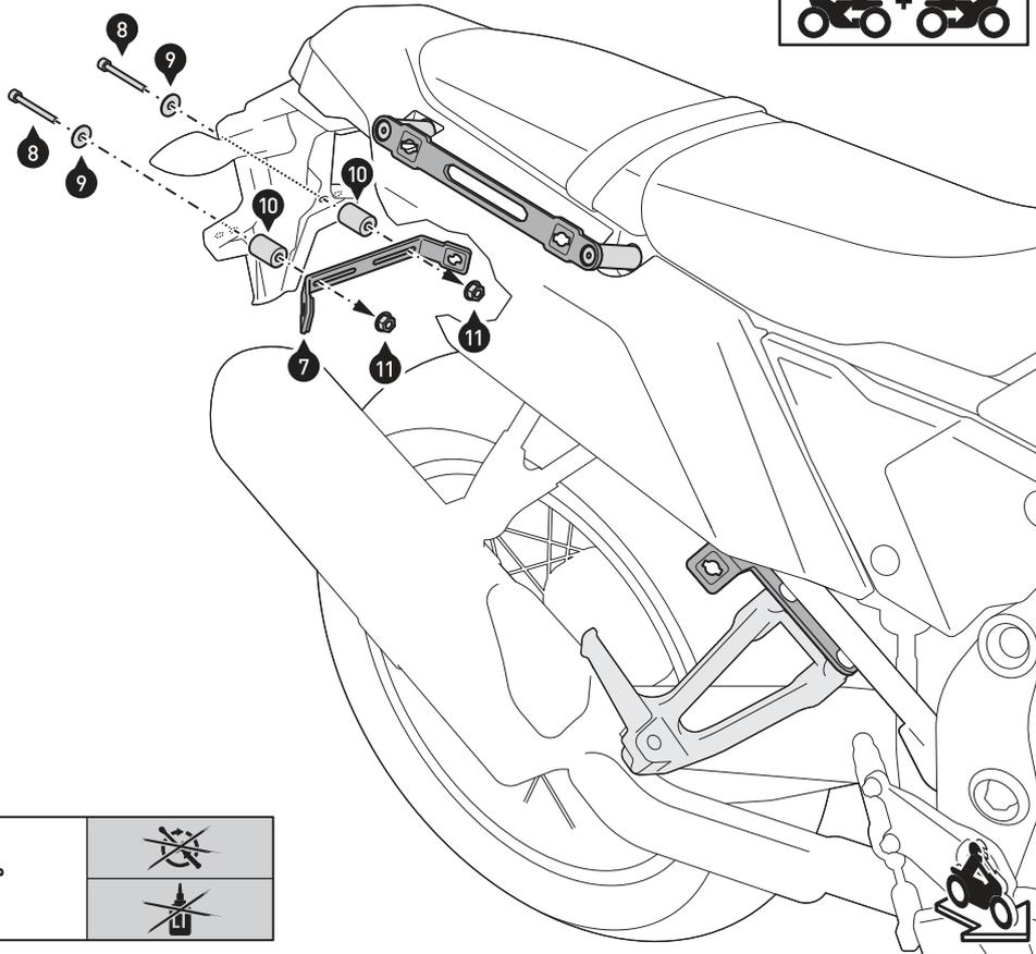
**HINWEIS:** Falls der original Zubehör-Kennzeichenhalter montiert ist, entfällt dieser Montageschritt. Montieren Sie den Querverbinder (7) mit den Schnellverschlüssen (13) zwischen den Seitenträgern (12), wie in Schritt [4] gezeigt. Die Teile (8) bis (11) entfallen.
