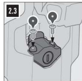
**Installazione della serratura del DUSC**
