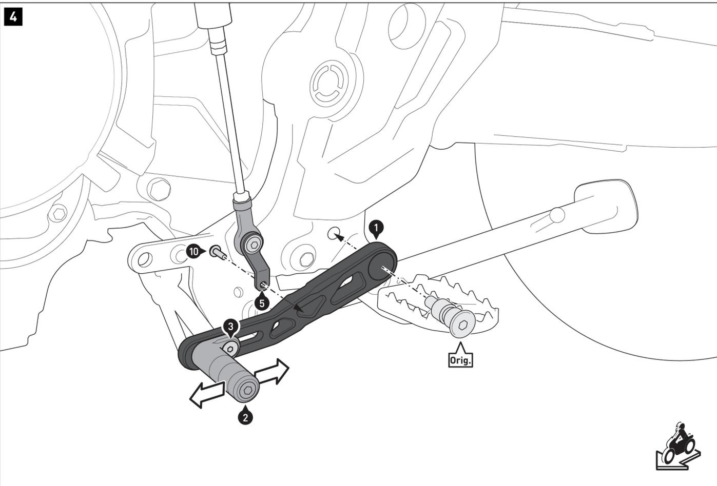
Avvitare la piastra della leva del cambio [5] alla leva del cambio [1].
