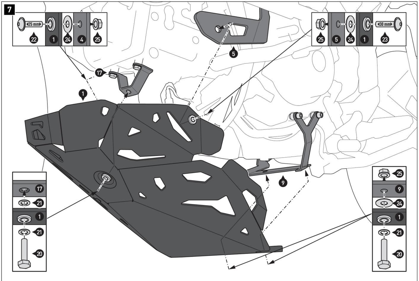
Avvitare la protezione motore (1) alle staffe di montaggio (4), (5), (9) e (17).
