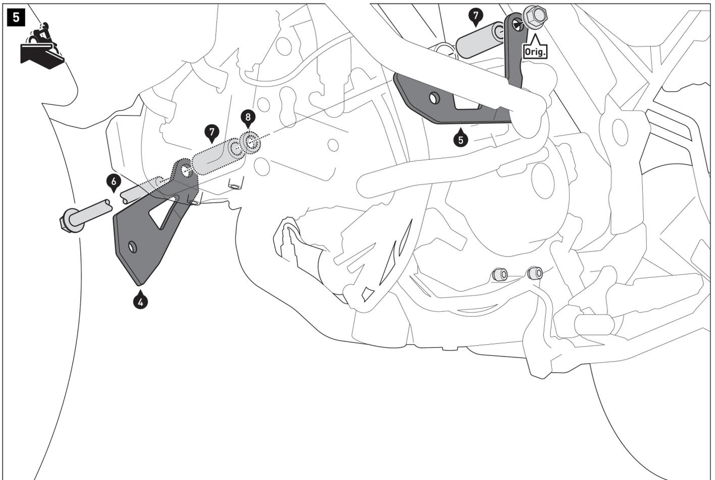
**AVVISO:** utilizzare le parti indicate quando si monta contemporaneamente la barra di protezione SW-MOTECH. Le barre di protezione vengono avvitate sulle staffe di montaggio (4) e (5).
