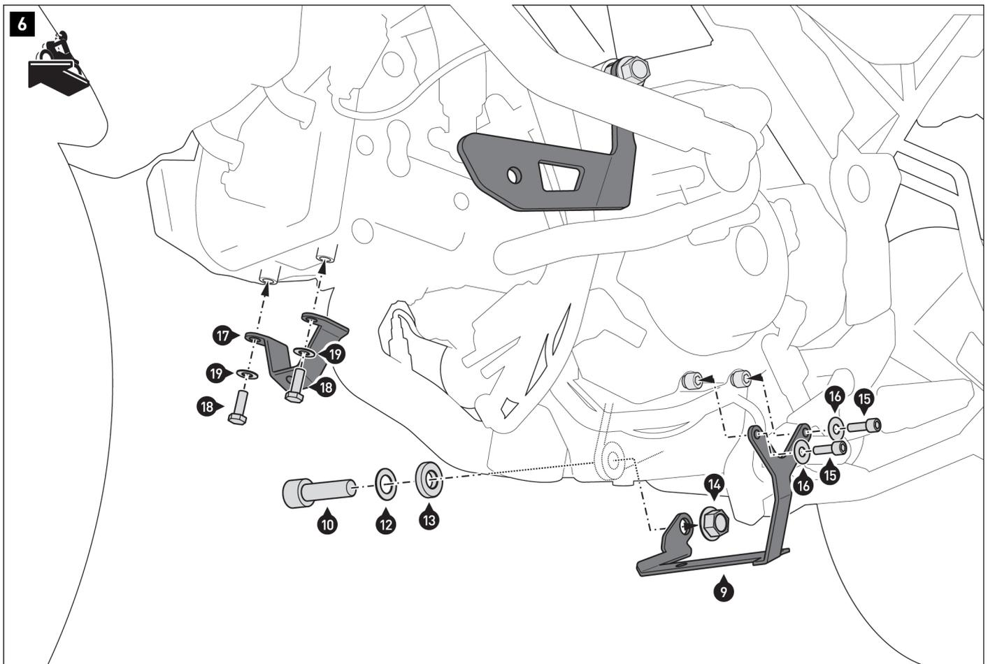
**⚠AVVISO:** per il montaggio contestuale al cavalletto centrale SW-MOTECH, utilizzare la vite (11) sul punto di fissaggio sinistro. Le parti (12) e (13) non devono essere montate. Utilizzare invece le parti del cavalletto centrale.
