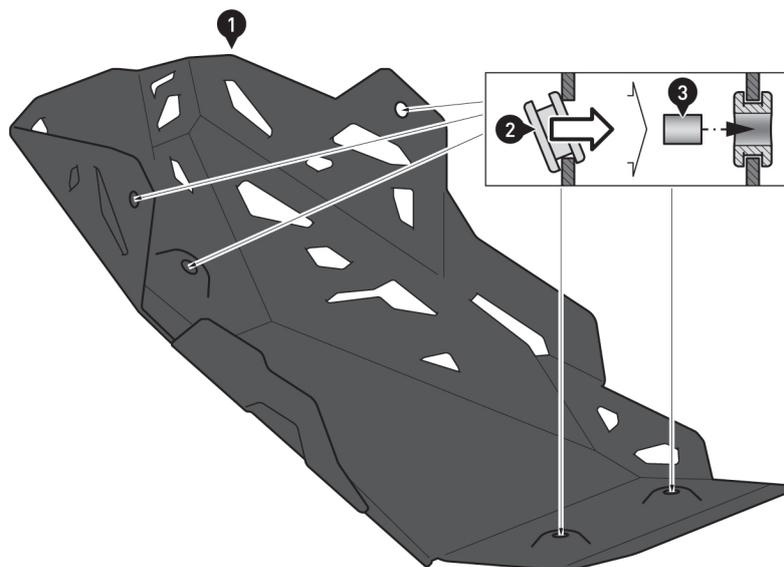
Inserire gli anelli in gomma (2) nelle aperture della protezione motore (1).
