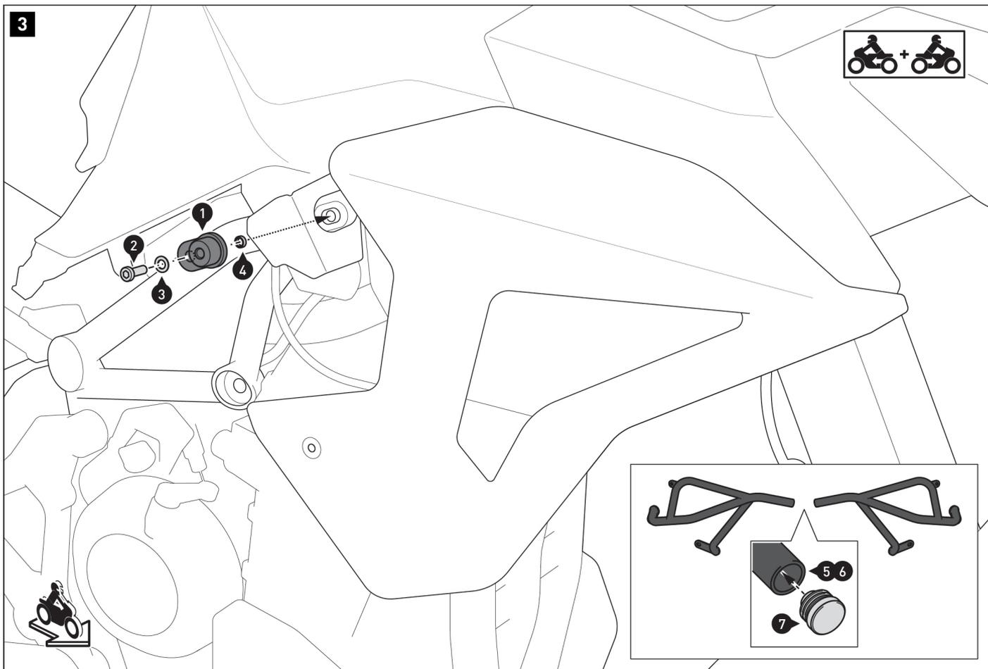
Avvitare la staffa di montaggio (1) sotto il rivestimento in gomma al veicolo.
