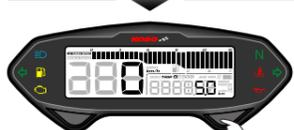
● Nel display Contachilometri parziale A, premere una volta il tasto **Regola** per passare al display Contachilometri parziale B.
