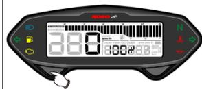
● Nel display del livello del carburante, premere il pulsante **Seleziona** una volta per tornare al display dell'orologio.
