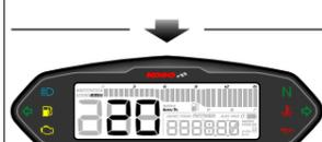
● Nel display registrazione velocità media, premere il tasto **Regola** una volta per inserire il display ODO.
