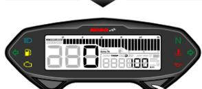
● Nel display Chilometraggio manutenzione olio, premere il tasto **Regola** una volta per attivare il display Ore totali.
