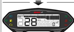
● Nel display di registrazione massima, premere il tasto **Regola** una sola volta per accedere al display registrazione di velocità media.
