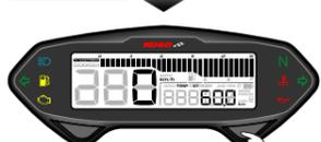
● Nel display Contachilometri parziale B, premere il tasto **Regola** una volta per attivare il display Chilometraggio manutenzione olio.
