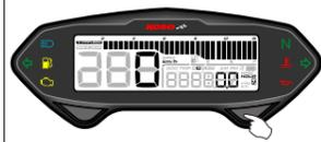
● Nel display ore parziale B, premere il tasto **Regola** una volta per entrare nel display registrazione massima.
