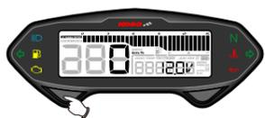
● Nel display Voltmetro, premere il pulsante **Seleziona** una sola volta per accedere al display del livello del carburante.
