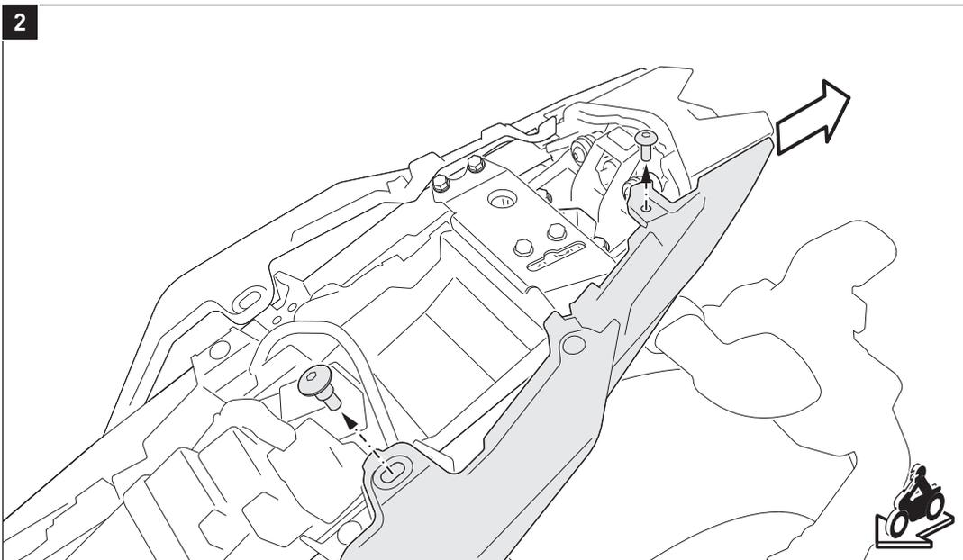
Lösen Sie die gezeigten Schrauben der hinteren Seitenverkleidungen. Ziehen Sie die Seitenverkleidungen vorsichtig aus den hinteren Führungen.
