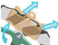
Scanalature alternate sulle due superfici del disco creano un meccanismo di auto ventilazione. Fango e sporco vengono rimossi con facilità dalla superficie frenante.</p> |
