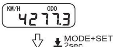
Per entrare nella modalità calibrazione tenere premuti contemporaneamente per due secondi i pulsanti SET e MODE. Esistono due metodi di calibrazione:
