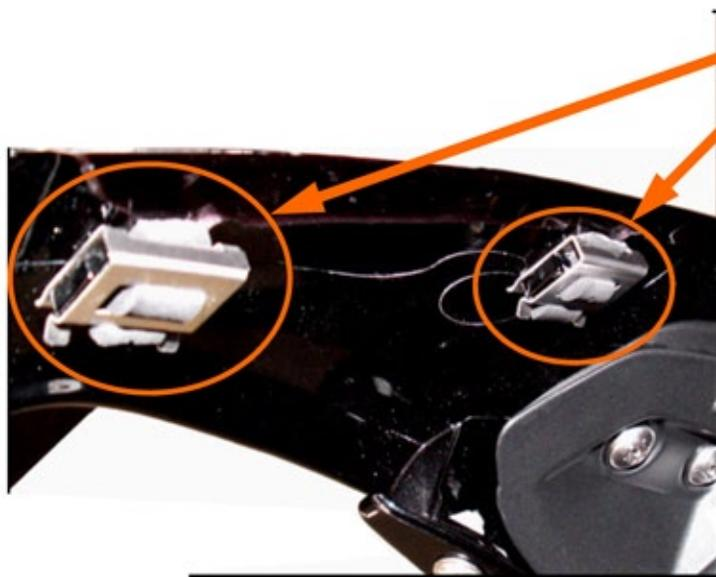
Applicare la schiuma sulle alette prima del montaggio in modo da far posizionare la schiuma dentro le clip di fissaggio
